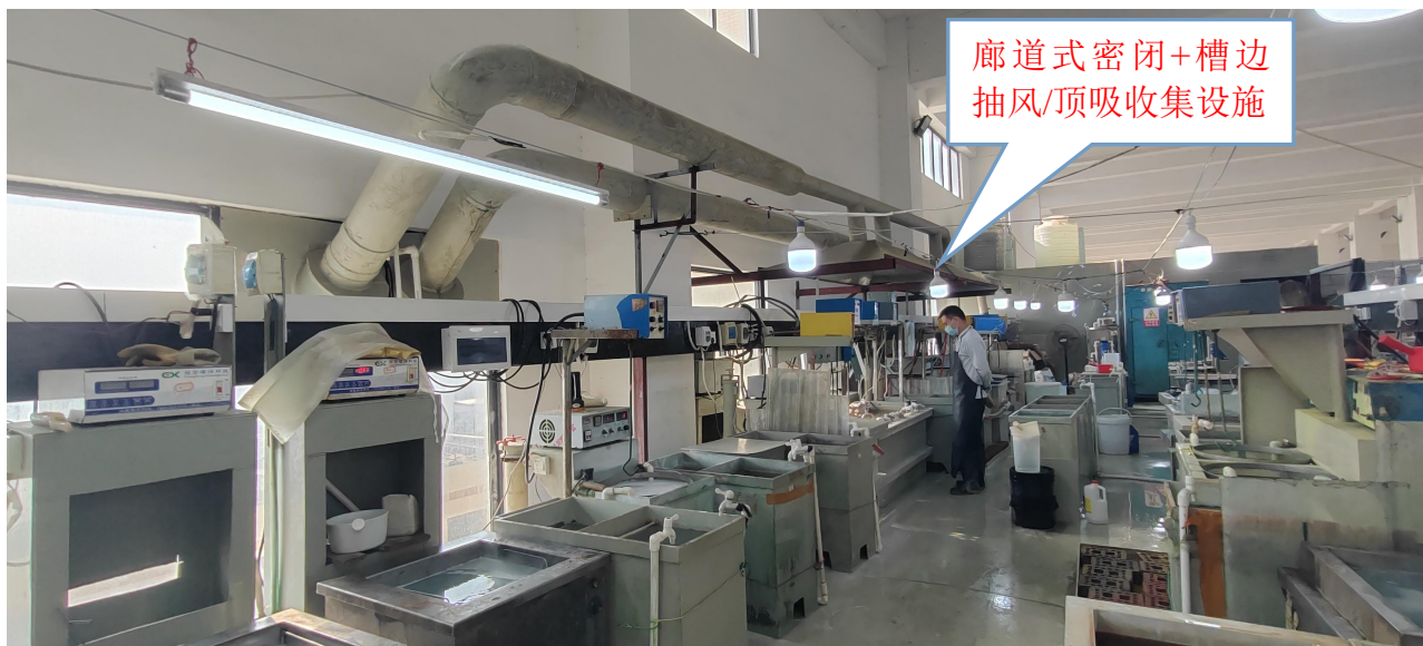
5号厂房第3层挂镀镍、镀白铜锡生产线
