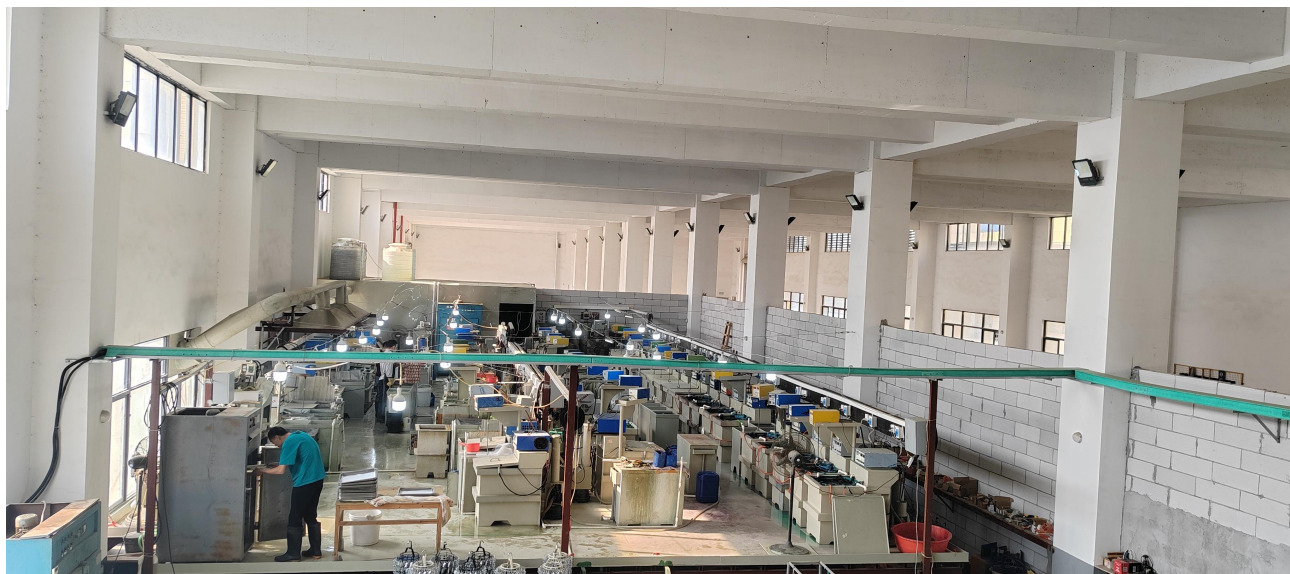
5号厂房第3层挂镀镍、镀白铜锡生产线
