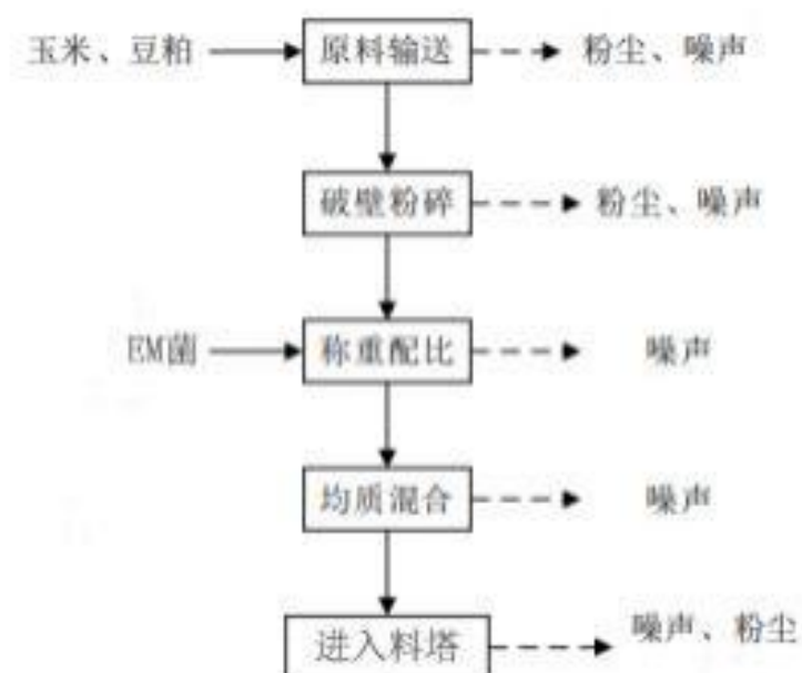
图2.2-4 饲料加工工艺流程及产污环节图
