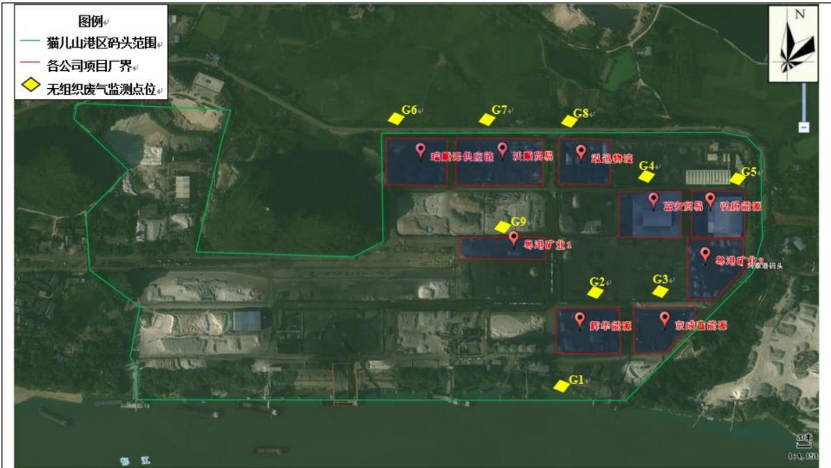
图 3-1 无组织废气监测点位示意图
