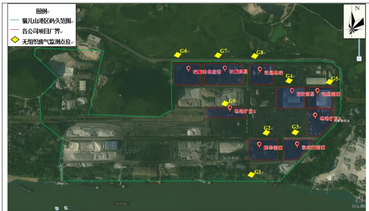
图 3-1 无组织废气监测点位示意图
