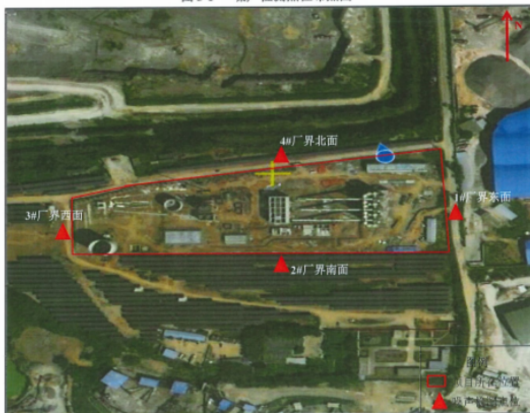
图 5-1 噪声检测点位布点图
