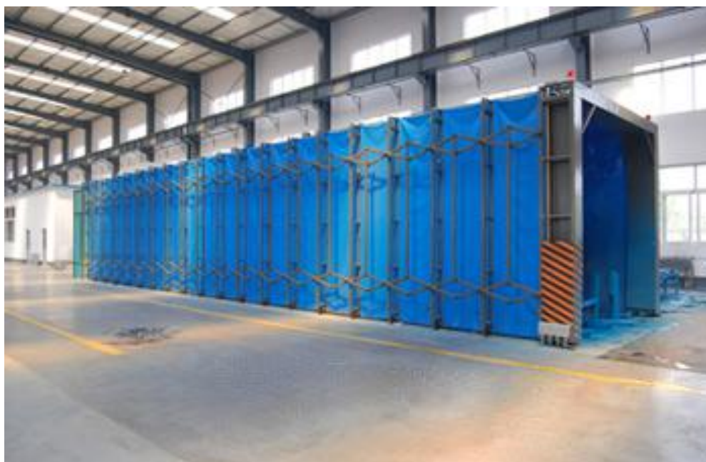
图 5.2-3 伸缩式移动喷漆房实例（展开状态）
