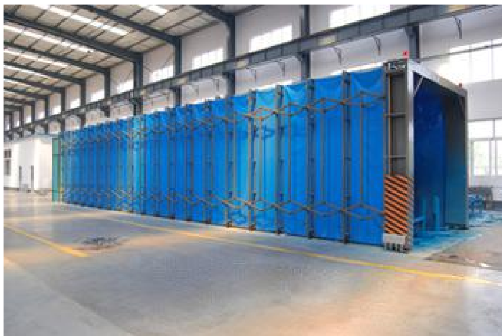
图 2.2-4 伸缩式移动喷漆房实例（展开状态）
