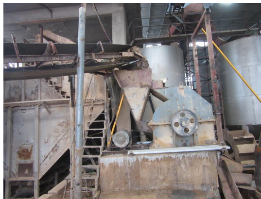
制砂机（湿式破碎，自带筛分）
