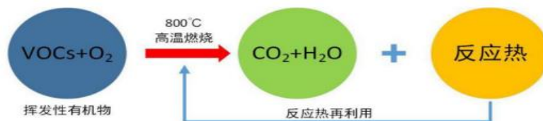
图 3-4 燃烧法废气分解原理
